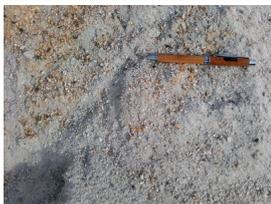
Utilisé principalement pour la pose de fourreaux et de canalisation, permet également de rehausser le niveau de terrain
