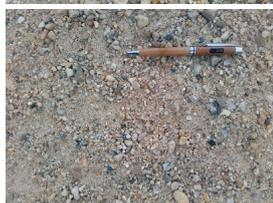
Mélange de sable et de grave de granulométrie 0/14 prêt à l'emploi destiné à la réalisation de béton
